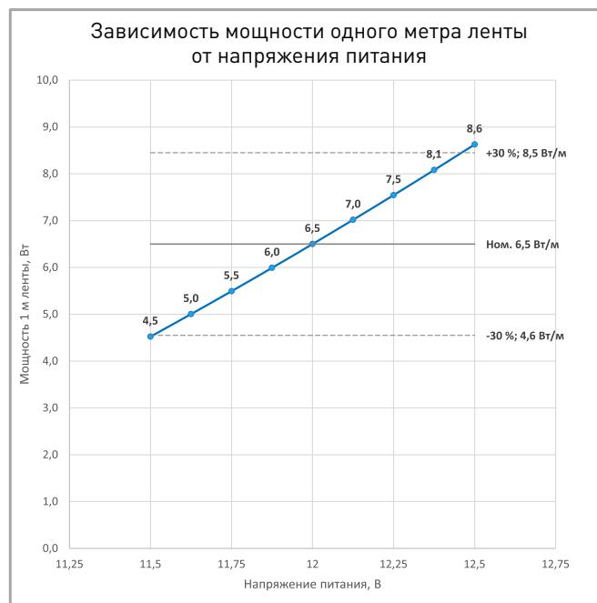
Удельная мощность ленты снижается при увеличении длины подключаемого отрезка из-за падения напряжения по длине ленты.
