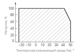
Рис. 2. Максимальная допустимая нагрузка, % от мощности источника
