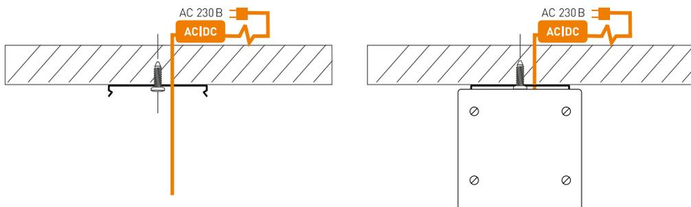
Рис. 2. Монтаж светильника
