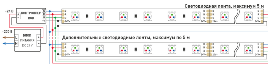
Черный провод - общий «+», красный провод - «R», зеленый провод - «G», синий провод - «B»
