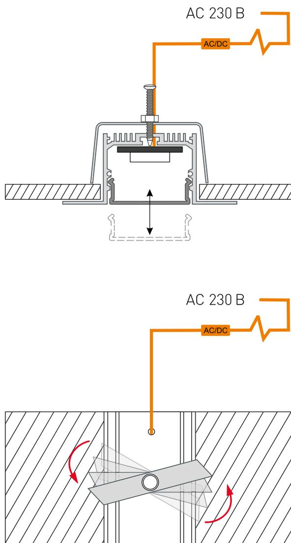
Рис. 1. Установка и подключение светильника
