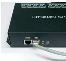
Рис. 2. Подключение контроллера HX-801RC к мастер-контроллеру или компьютеру.
